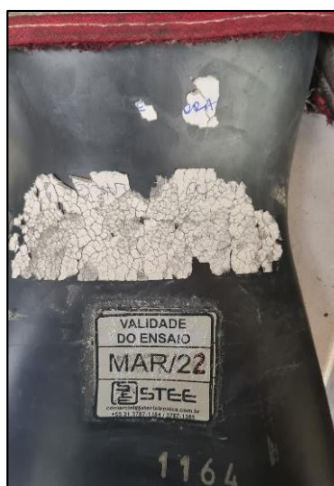
Figura 31 – Ensaio da luva de borracha na validade
