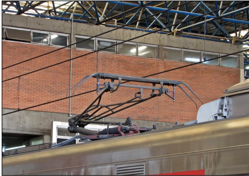
Figura 24 – Contato entre o Pantógrafo do trem e a rede aérea
